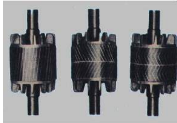
Şekil- 1.4 : Kısa devre çubuklu rotor.
