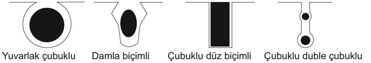
Şekil- 1.3 : Rotor çubuk biçimi ve kesiti
