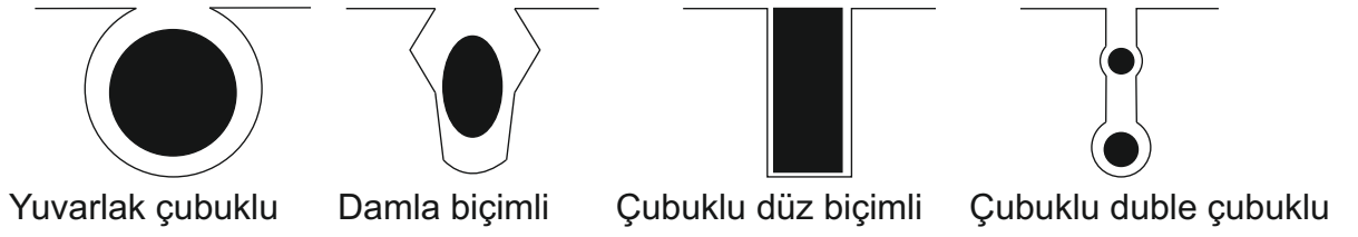
Şekil- 1.3 : Rotor çubuk biçimi ve kesiti
